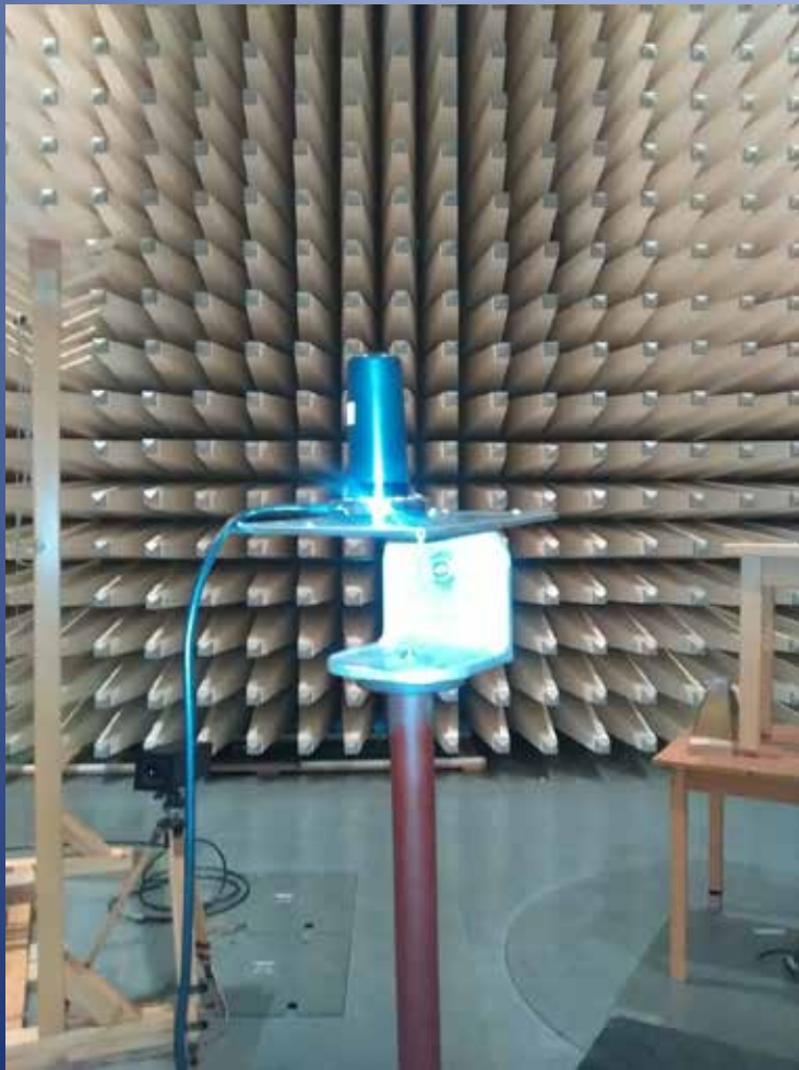
Všesmerová anténa kalibrovaná v pásme 700 MHz – 3,7 GHz
